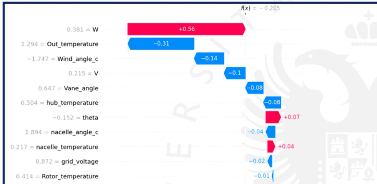
SHAP nos permite evaluar el impacto de las demás variables de entrada en la variable de salida (potencia generada).
