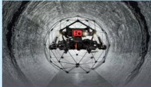
Inspeccionar zonas de muy difícil acceso y peligrosas. Con un sistema de **navegación autónoma** basado en lidar a bordo del dron y perfectamente sincronizado con el autopiloto, que también es de diseño y fabricación propia. Con este enfoque consiguen una navegación totalmente autónoma del dron.
